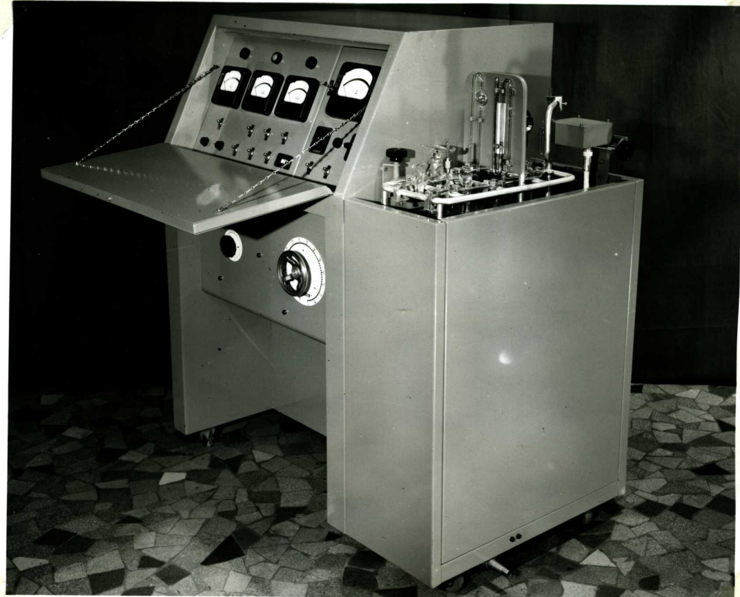
Figure 14 - Spectromètre U.H.F. en position de travail
