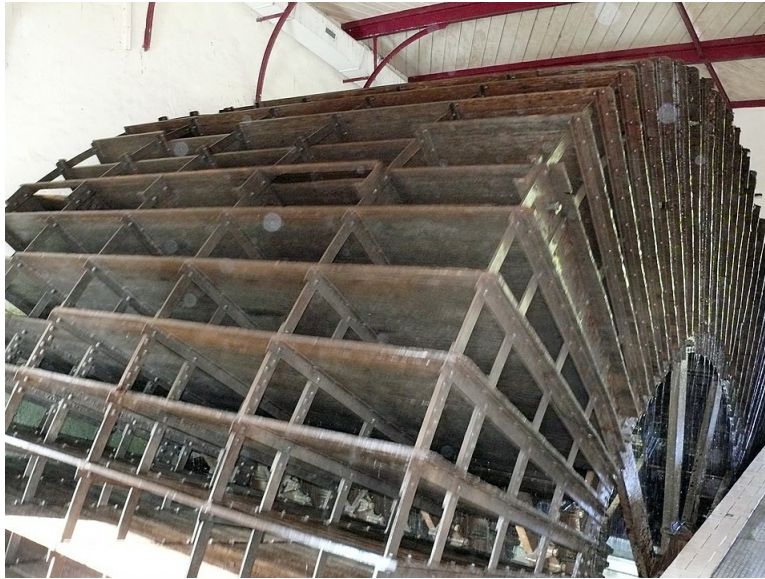
Roue de 11 m de diamètre installée à l'usine élévatoire de Trilbardou.
